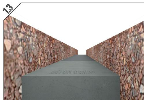
Creuser une tranchée pour l'installation du caniveau et de sa grille à fente. La tranchée doit être plus profonde d'au moins 15 cm et plus large de 30 cm (15 cm de chaque côté).
