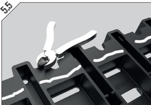
Casser la/les languette(s) d'indexation. Déposer du mastic sur les surfaces planes au verso de la grille.
