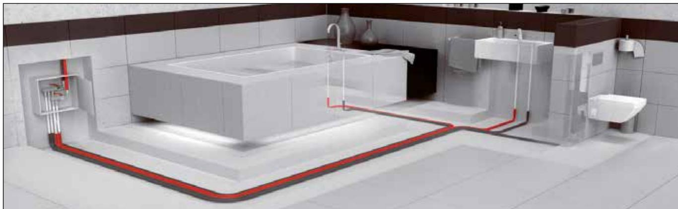
Avantage : les pertes de pression sont faibles si deux points de puisages sont utilisés simultanément.
