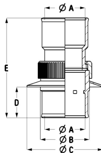
Raccord pour canalisation démontable – Dimensions (mm)
